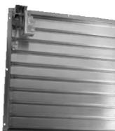
L'option motorisée améliore la protection contre les intempéries en assurant une fermeture plus étanche et est recommandée pour toutes les applications d'approvisionnement. Les registres robustes sont construits avec des cadres et des lames galvanisés et ont une capacité de 3000 FPM. Le corps du registre n'est pas encastré, ce qui permet un dégagement supplémentaire entre le ventilateur et les lames du registre.
