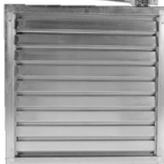
Ce registre peut réduire considérablement l'infiltration d'air extérieur et, bien qu'il ne soit pas complètement étanche, il offre une protection contre les intempéries de manière économique. Construit avec un cadre galvanisé et des lames en aluminium, ce registre a une capacité de 2000 FPM avec le dégagement approprié fourni par tous les accessoires d'usine. Le corps du registre est encastré dans l'ouverture pour une apparence affleurante.
