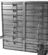
Le registre à cadre bridé est conçu pour s'encaster à l'intérieur des brides du boîtier mural ou du collier de montage mural en option. Le registre à pivot central offre une résistance supérieure aux intempéries. La construction galvanisée (aluminium en option) est prévue pour 3500 FPM avec un dégagement adéquat fourni par tous les accessoires d'usine.
