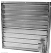
Ce registre a un cadre à brides et est conçu pour s'adapter aux brides intérieures du boîtier mural optionnel ou du collier de montage mural. Le cadre et les lames sont construits en acier galvanisé et ont une capacité de 3000 FPM avec un dégagement adéquat fourni par tous les accessoires d'usine. Le corps du registre s'encastre dans l'ouverture pour une apparence affleurante.
